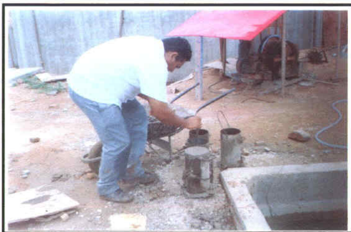
Foto 05 – Detalhe da moldagem dos corpos de prova do reservatório de 600 m 3 .
