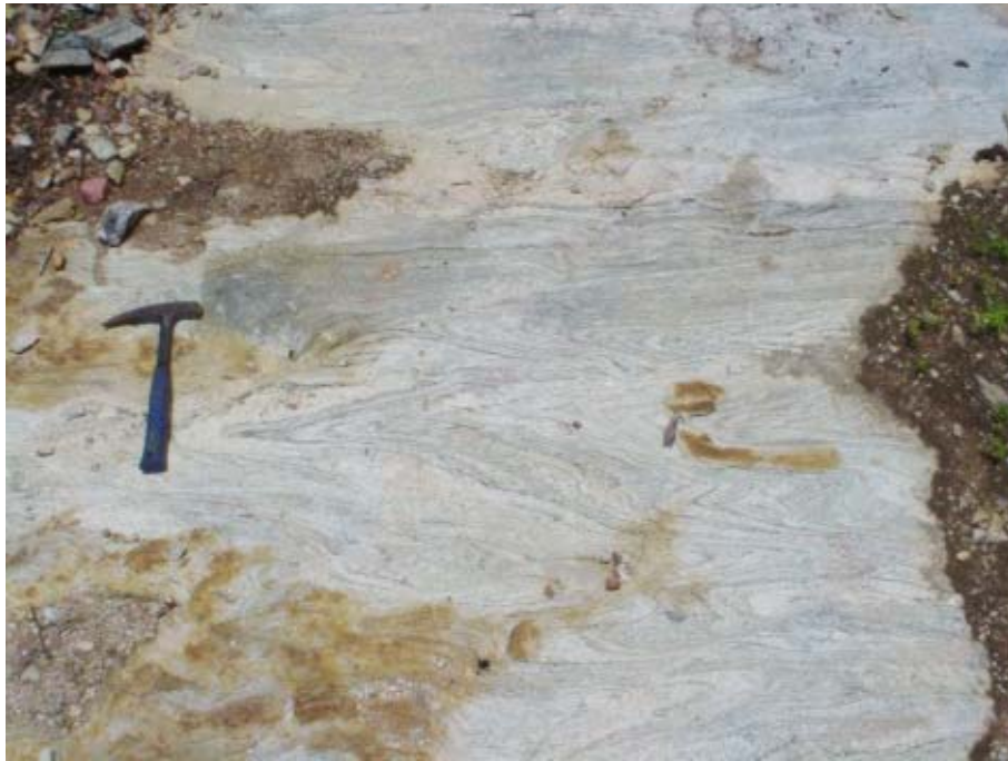
Migmatito (Unidade 2) exibindo estruturas dobrada e “schlieren”, cortado por veio pegmatóide, aflorante no eixo do canal nas proximidades do aqueduto Cipó.
