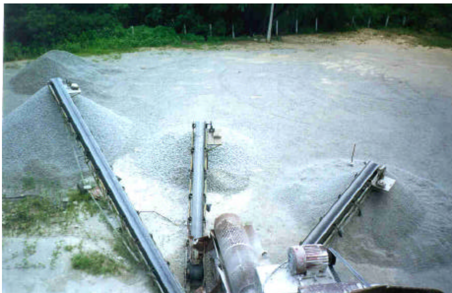
FOTOS 45 e 46: Britador na Região de Salgueiro, com três tamanhos: Brita 0 - Brita 1 - Pedrisco.
