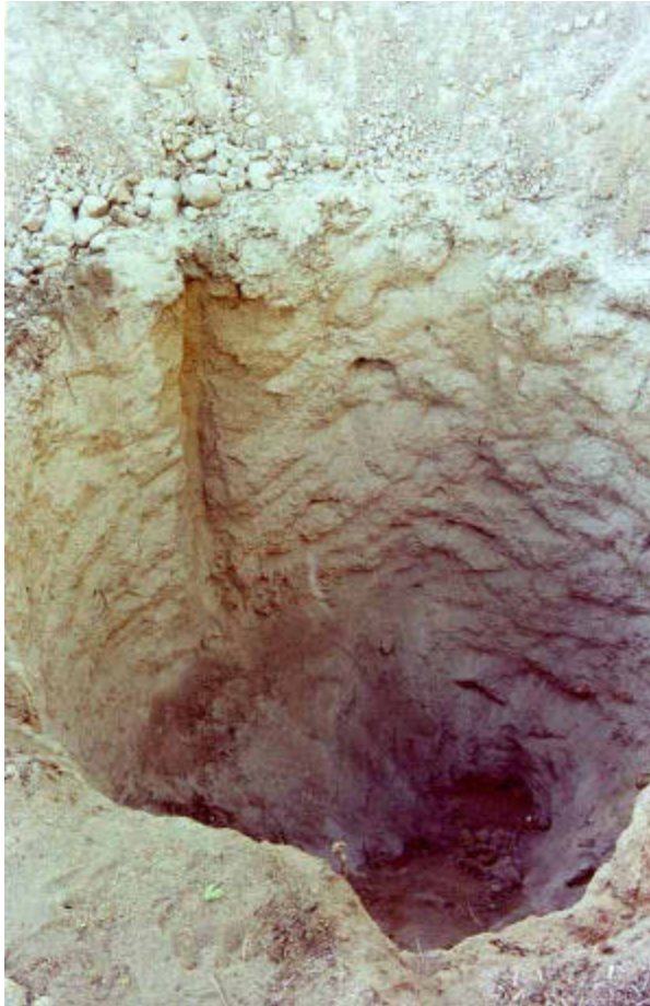
PN-01 - Foto 1: A canaleta representa o trecho amostrado. Os últimos 40 cm foram em rocha muito fraturada.
