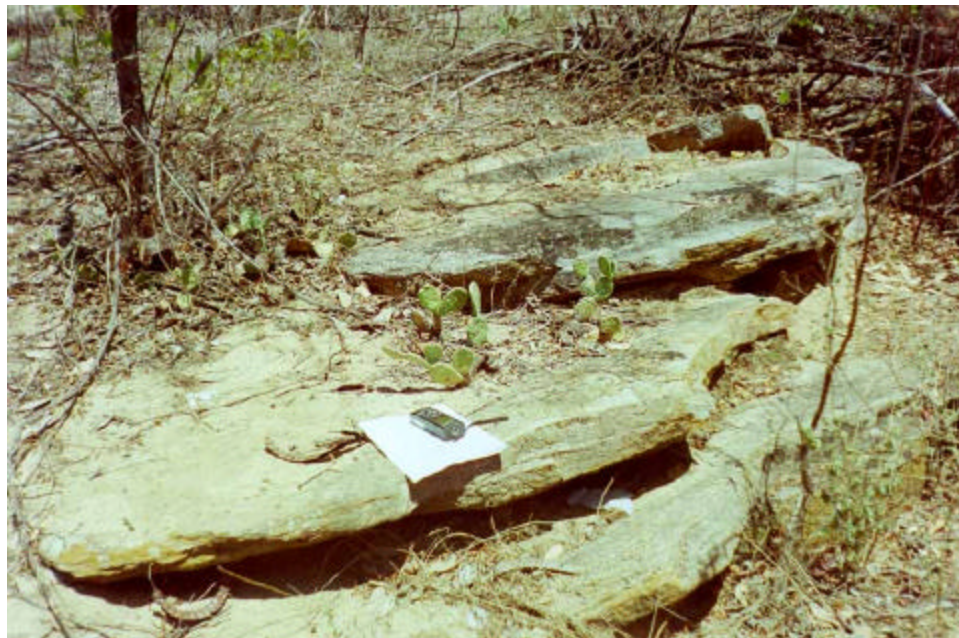
FOTO 36: Aqueduto Logradouro – Rocha aflorante a subaflorante. Gnaíse com bandamento pronunciado, o qual constitui planos de fraqueza da rocha. Atitude N65W/32°NE.
