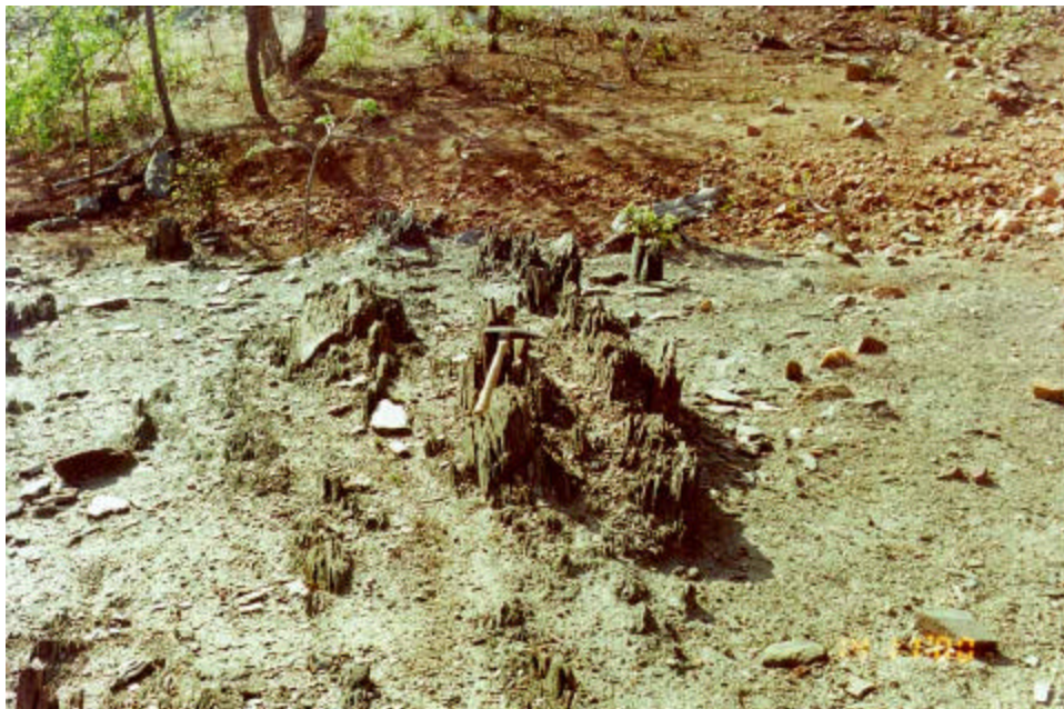
FOTO 7: Barragem Terra Nova - Afloramento de clorita xisto próximo (~ 500 m) ao eixo.
