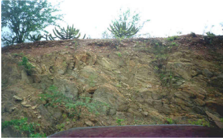
FOTO 41: Jaz.03 (Terra Nova) - Pequeno serrote de rocha granitóide pouco foliada. Granito-gnaissé com boa potencialidade para uso como Pedreira.
