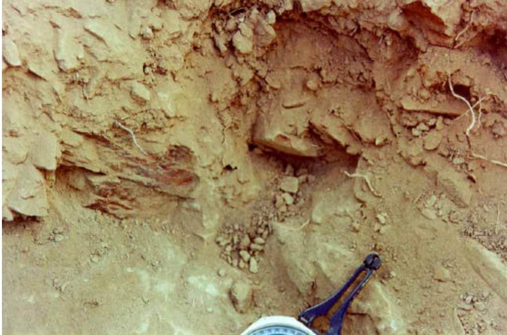
PJ-01 - Foto 2: Detalhe da foliação da rocha (N60E/55°SE)
