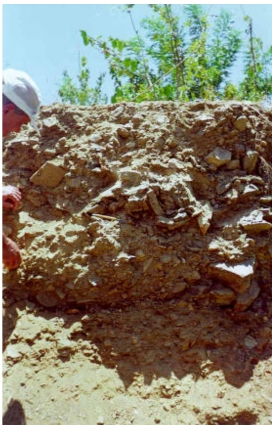
Bota-Fora de Atalho - Foto 2: Material depositado no bota-fora, oriundo da escavação do vertedouro Atalho (local de implantação da Barragem Logradouro).
