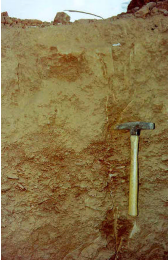
PJ-03 - Foto 1: Vista da parede do poço. Aluvião, no contato entre horizonte fino no topo e conglomerático na base.
