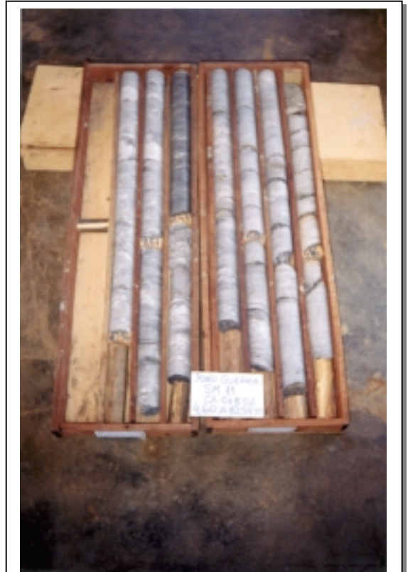
FOTO 02 - SM-11-CAIXA-01 e 02 TRECHO:4,60m a 10,54m
