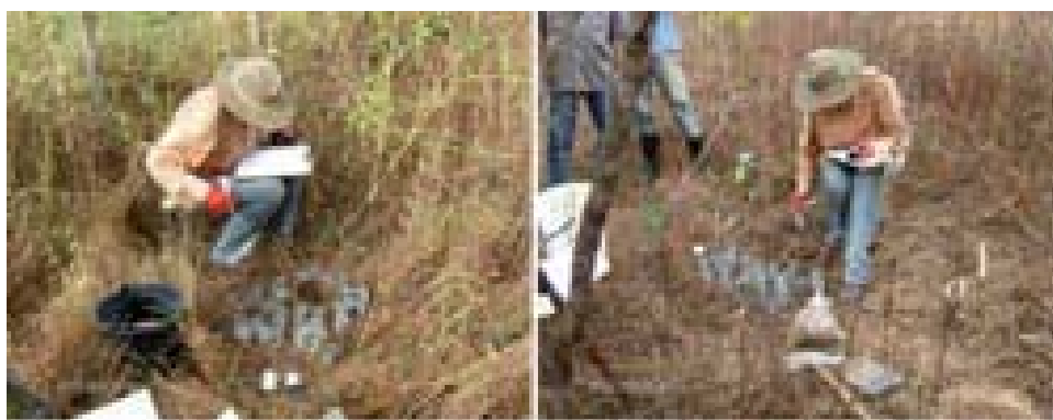
FOTO 2.11 – Ensaio de infiltração método de Beerkan
