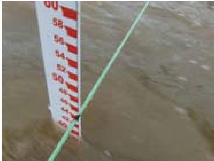
FOTO 2.18 – Medição da profundidade
