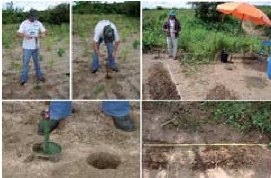
FOTO 2.19 – Etapas de uma sondagem a trado durante os trabalhos de campo.
