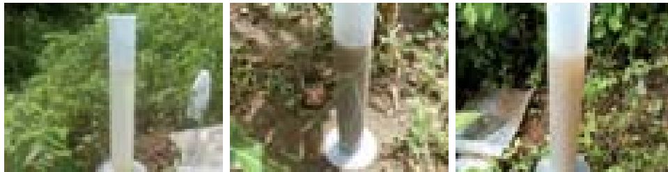
FOTO 3.07 – Diferença de turbidez observada nas provetas durante a medição do volume.
