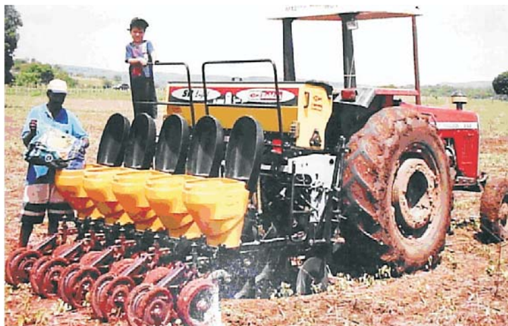
Foto 8 – Semeadora Tração Motora de 5 Linhas Fonte: Néri Gonçalves – 2006.
