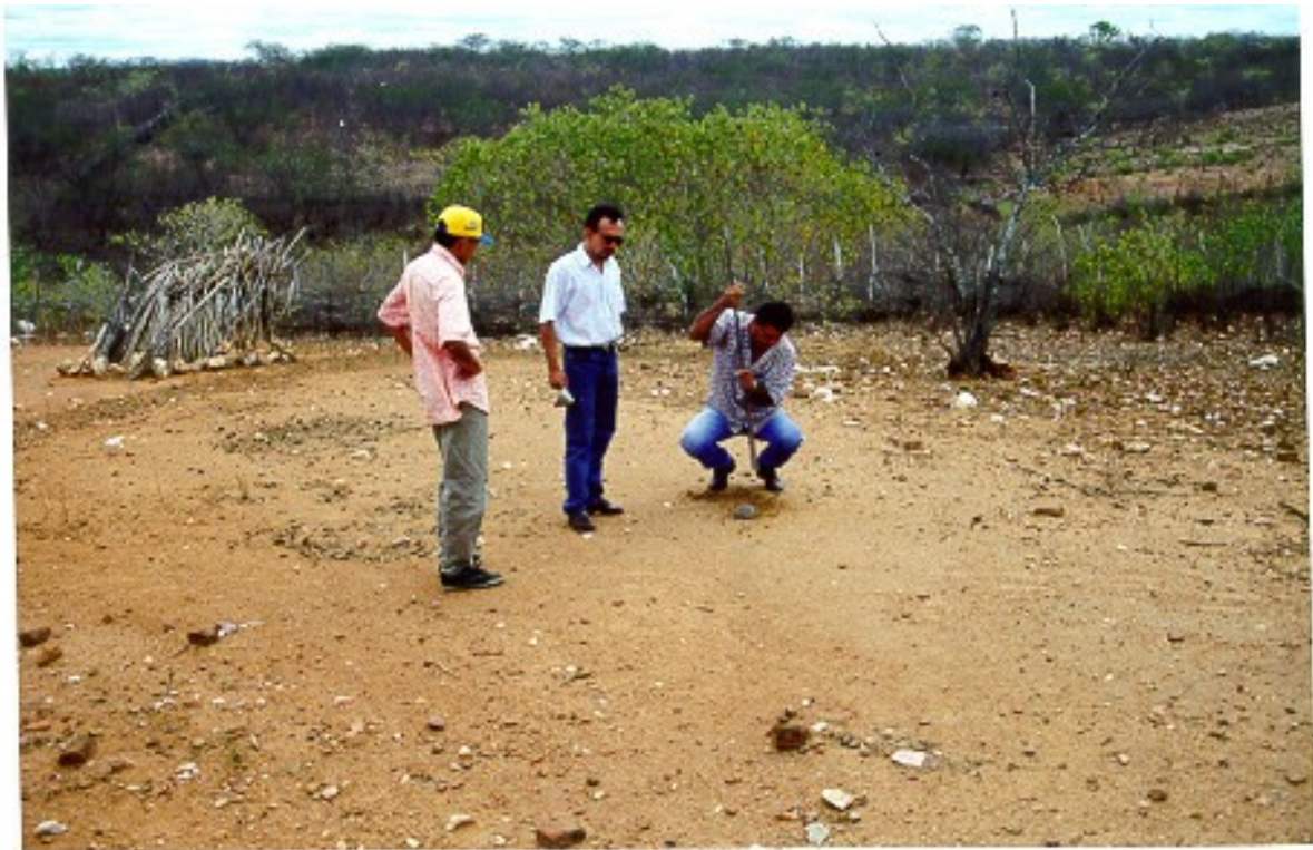
Figura 4: Perfuração do local para a haste de suporte do pluviômetro.
