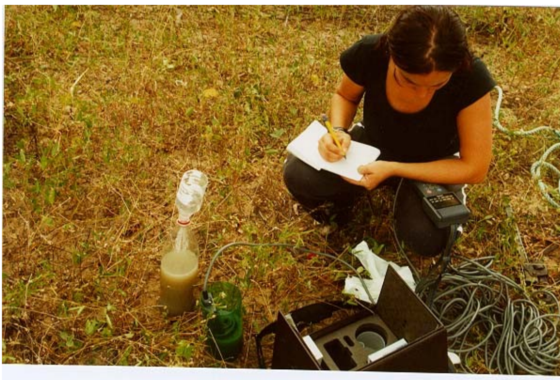
Figura 19: Determinação e registro, no campo, de parâmetros de qualidade de água, principalmente salinidade. (Outros parâmetros podem ser medidos no campo como Temperatura, OD, etc.)
