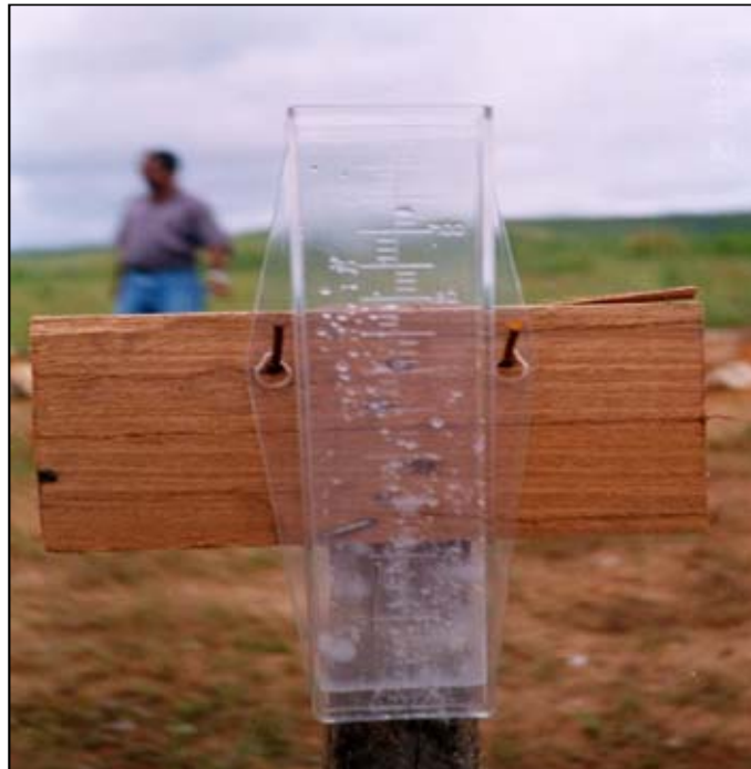
Figura 4.15- Pluviômetro instalado na área em estudo, 2002.
