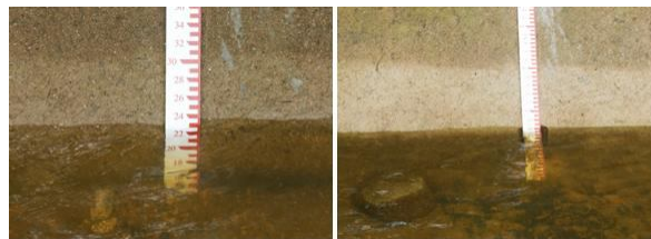
Foto 8: Medição do nível d'água na calha do riacho do Salgadinho.
