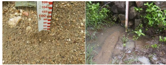
Foto 4: Instalação de régua limnimétrica em barragens sucessivas.
