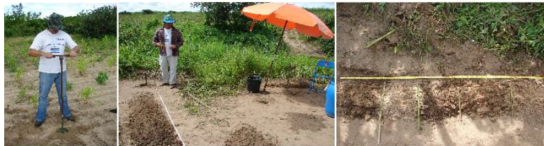
Foto 11: Etapas de sondagem a trado em uma das barragens subterrâneas
