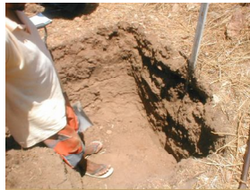
Foto 14: Abertura de trincheira e amostragem
