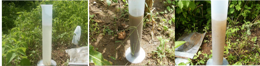
Foto 13: Diferença de turbidez observada nas provetas durante a medição de volume.
