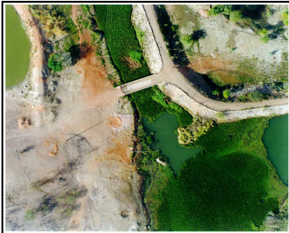
Foto 33/44 - Vista parcial do Canal do Trabalhador a cerca de 2,0 km do ponto de captação d'água na Barragem de Itaipava. Observa-se neste trecho o canal de adução tomado por vegetação aquática, podendo vir a ocorrer redução do fluxo d'água e obstrução de sífoes e outras infra-estruturas. Caso essas plantas sejam tóxicas pode haver comprometimento da qualidade da água aduzida.
