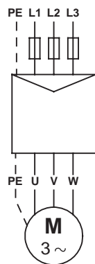
Afb. 14 Grundfos-motor: directe inschakeling
