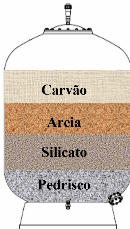
Figura 8.4 – Corte Lateral de um Filtro Multimeios
