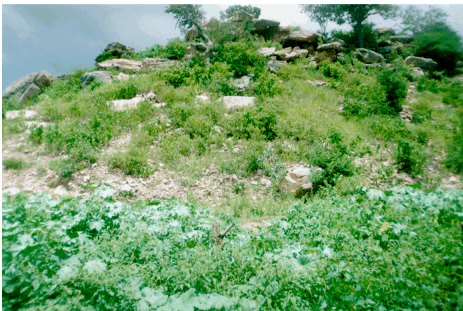
FOTO 03: Açu de Inhuçu: Local na ombreira esquerda indicado como pedreira, onde ocorrem blocos de arenito são.
