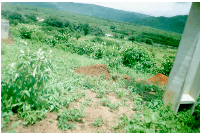
FOTO 05: Açude Fronteiras: Poços de sondagem exploratórios da área de empréstimo E-4, constituído de cascalho areno argiloso de cor variegada, de boas características para emprego em uma barragem de terra .
