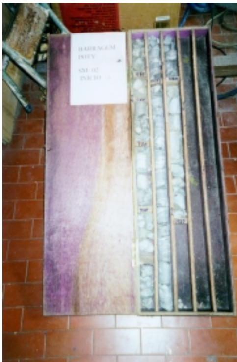
FOTO 07: Açude Fronteiras: Amostras do substrato rochoso extraídas na sondagem mista SM-02, na estaca 20+14 do eixo, entre profundidades 3,06 e 14,80m.
