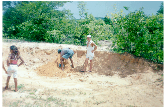
FOTO 02: Açude Paula Pessoa: Empréstimo E-1 de solo arenoso, estudado para possível utilização em barragem de terra.
