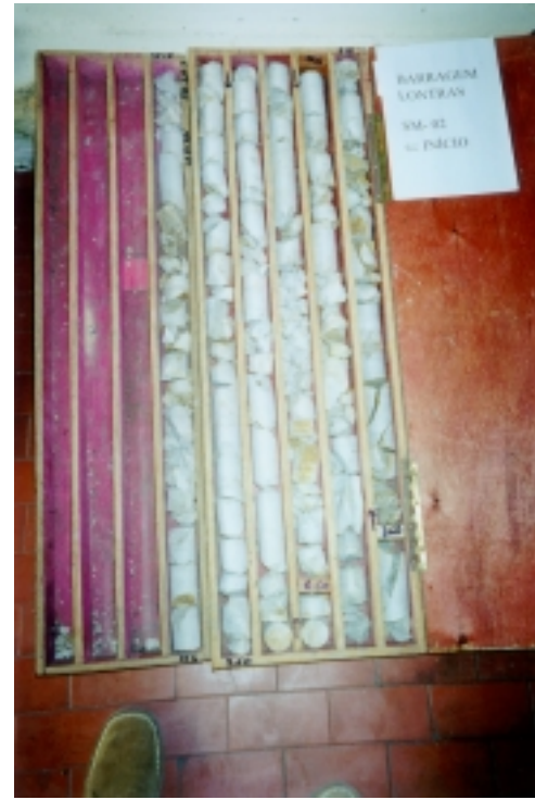
FOTO 02: Açude Lontras: Testemunhos da sondagem mista SM-02, executada na estaca 36+11 o eixo do barramento, entre profundidades 2,10 e 11,10m.
