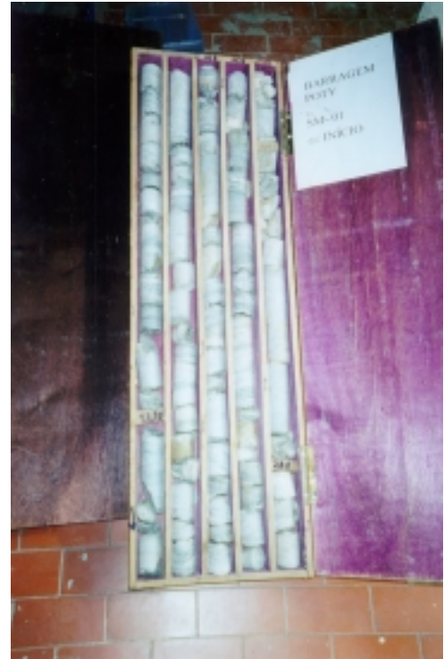
FOTO 06: Açude Fronteiras: Amostras do substrato rochoso extraídas na sondagem mista SM-01, na estaca 7+10 do eixo, entre profundidades 5,12 e 14,07m.
