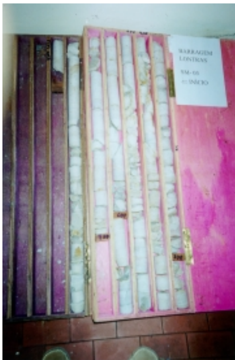
FOTO 03: Açude Lontras: Material recuperado da sondagem mista SM-03, executada na estaca 41+8,00 do eixo do barramento, entre profundidades 1,45 e 9,00m.
