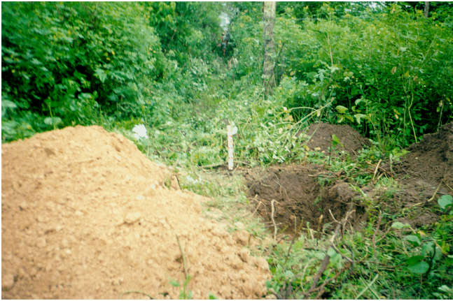
FOTO 01: Açude Cajueirinho: Foto do furo de sondagem realizado no empréstimo E-1, onde observa-se o horizonte de argila areno siltosa de cor variegada.
