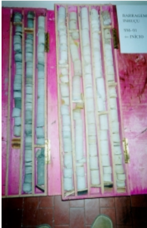
FOTO 05: Açude Inhuçu: Amostras do substrato rochoso extraídas na sondagem mista SM-02, na estaca 32 do eixo, entre profundidades 0,56 e 9,70m.
