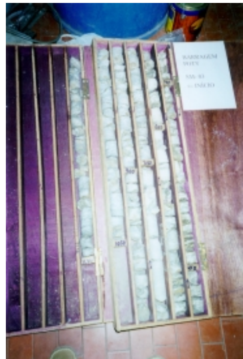
FOTO 08: Açude Fronteiras: Amostras extraídas do substrato rochoso através da sondagem mista SM-03, na estaca 30 do eixo, entre as profundidades de 2,34 e 11,34m.
