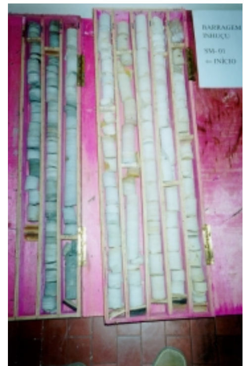
FOTO 04: Açude Inhuçu: Material recuperado da sondagem mista SM-01, executada na estaca 9 do eixo do barramento, entre as profundidades 1,20 e 10,20m.
