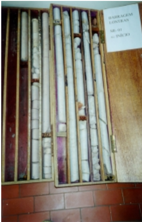
FOTO 01: Açude Lontras: Testemunhos da sondagens rotativa SR-01 executada no eixo do barramento entre profundidades 1,00 e 10,00m.
