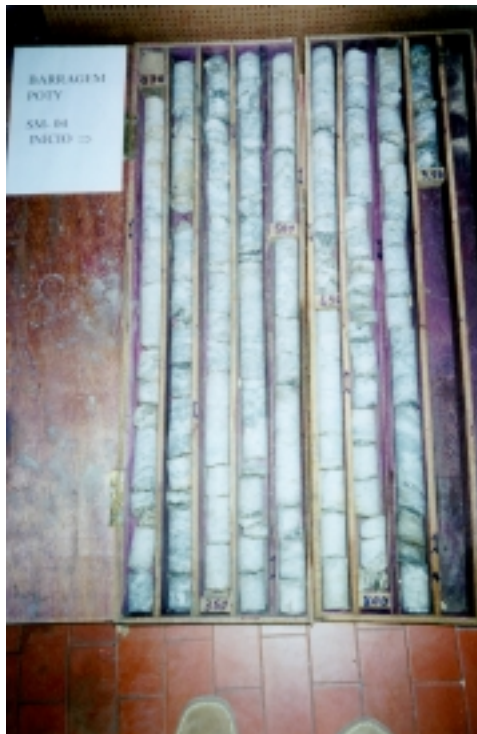
FOTO 09: Açude Fronteiras: Amostras extraídas do substrato rochoso através da sondagem mista SM-04, na estaca 39 do eixo, entre as profundidades de 0,30 e 9,30m.
