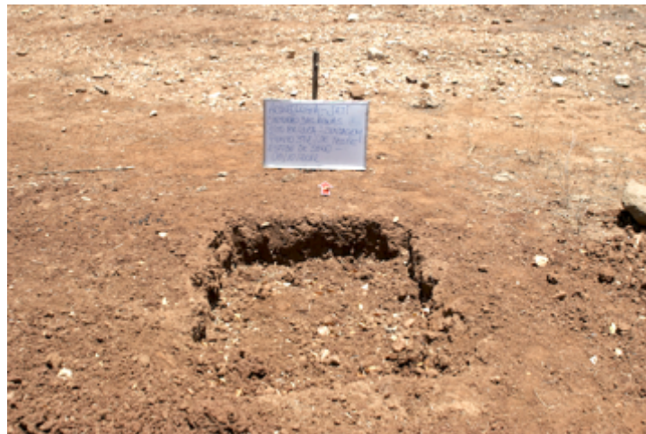
Figure 80: Sondagem para estudo de solo realizada pela VBA. Solo arenoso com granulometria de cascalhos grosseiros e coloração marrom. Sítio Beleza. Jati, Ce.
