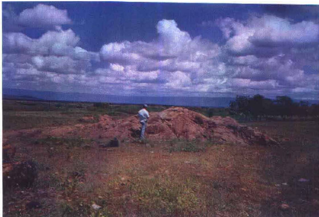
FOTO 03 – Afloramento de rochas metassedimentares na ombreira direita. Notar as intercalações de camadas conglomeráticas com areníticas. Fotografia tirada com vista para sul. A foto 4 mostra um detalhe do afloramento em questão.
