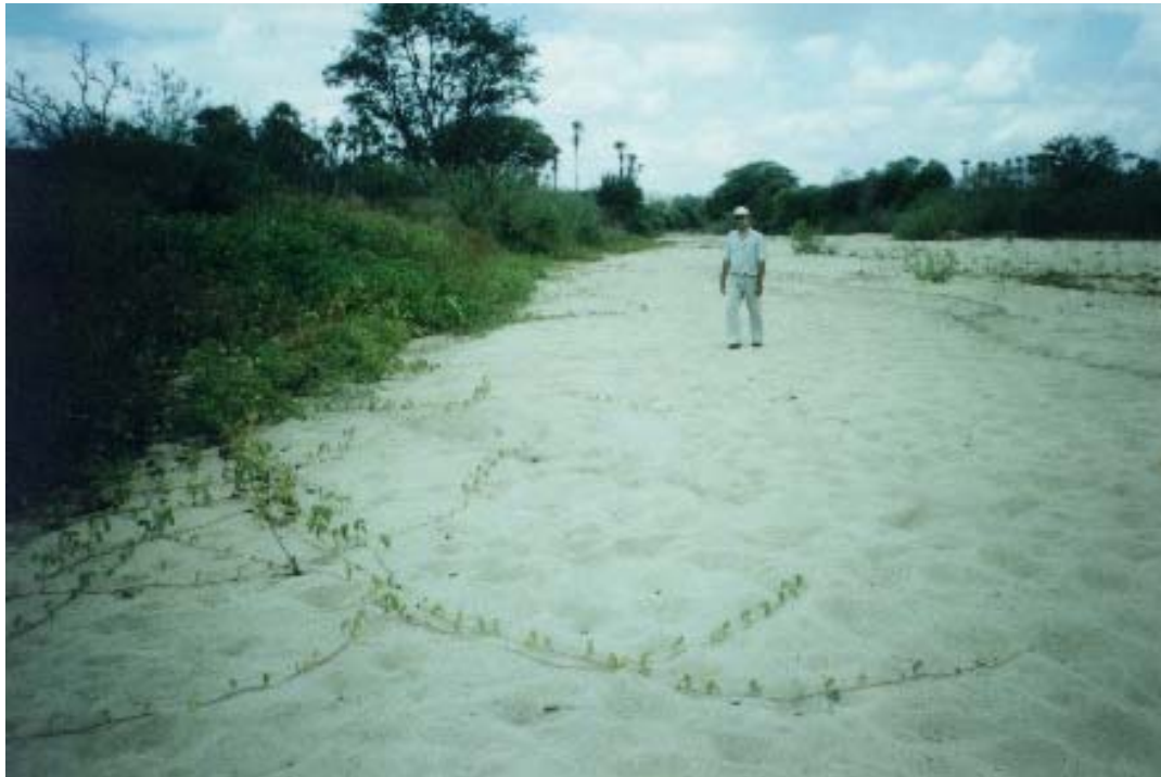
FOTO 09 – Bancos de areia no leito do rio Batoque, no local do eixo, selecionados como fonte de obtenção de material granular para os concretos e drenos necessários as obras da barragem.
