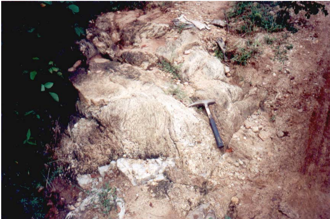
FOTO 09 - Afloramento de gnaiss alterado na margem esquerda do Riacho do Sangue, a jusante do eixo do barramento, apresentando xistosidade sub-vertical paralela ao talvegue do curso d'água.
