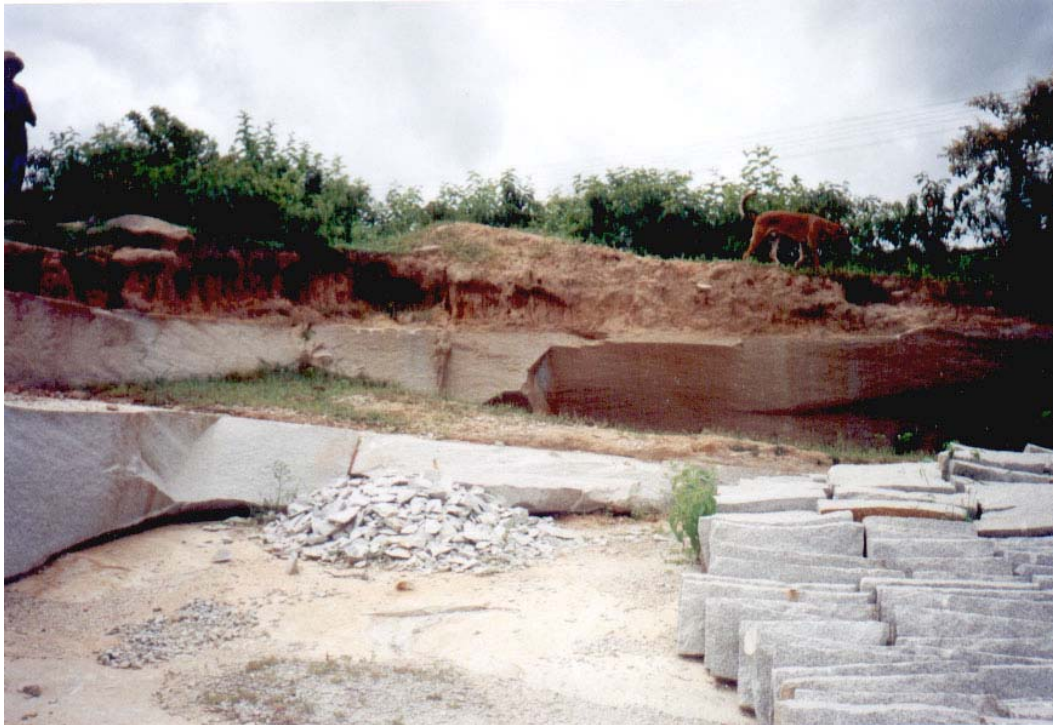
FOTO 01 - Afloramento de granito anatéxico em Irapuan Pinheiro, explorado como pedreira para produção de guias e paralelepípedos. Notar o fraturamento de alívio de tensões, paralelo à superfície (11/04/02).
