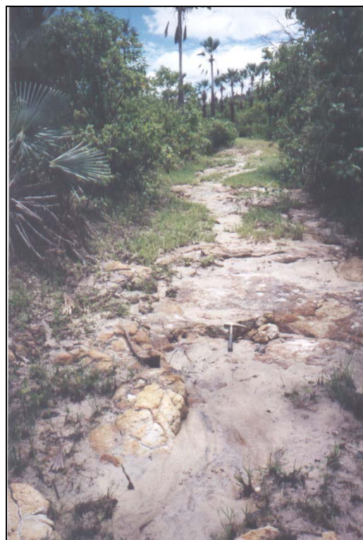
FOTO 14 - Arenito de Formação Barreiras fortemente cimentado, na porção baixa da ombreira esquerda do eixo (13/04/02).
