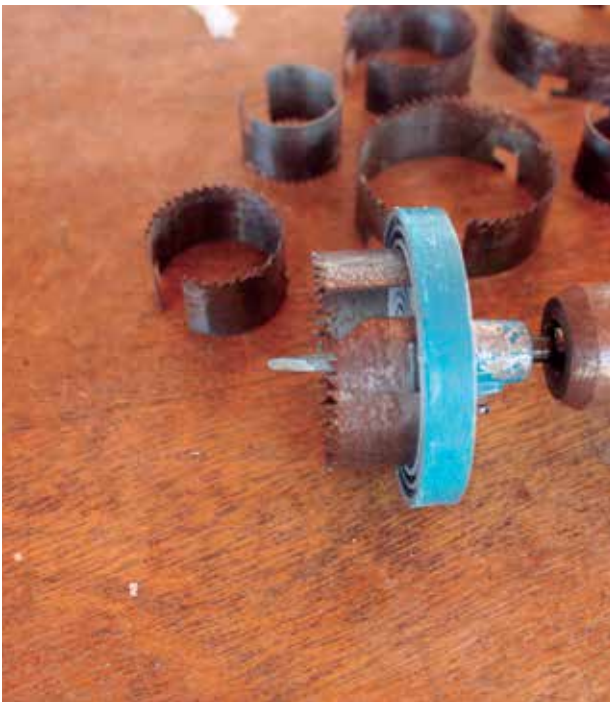
Furadeira com adaptador tipo copo para fazer um furo de 25 mm no fundo do balde.
