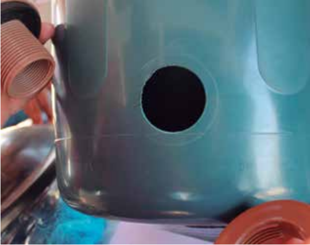
Balde sedimentador com furo para receber adaptador.
