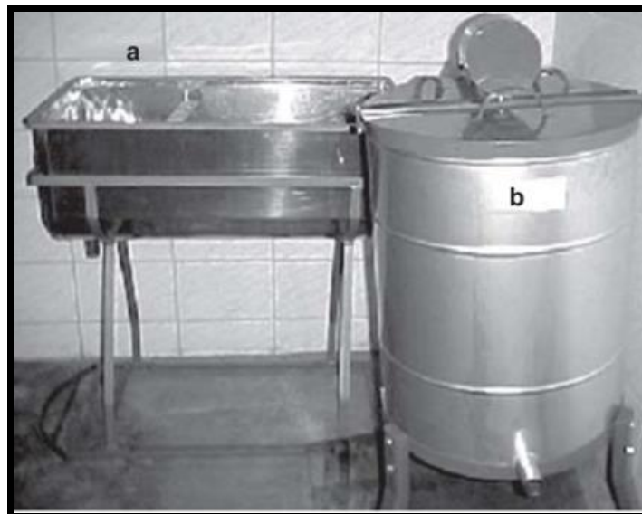
Figura 7.25 - Equipamentos utilizados na extração do mel: (a) Mesa desoperculadora e (b) Centrífuga.
