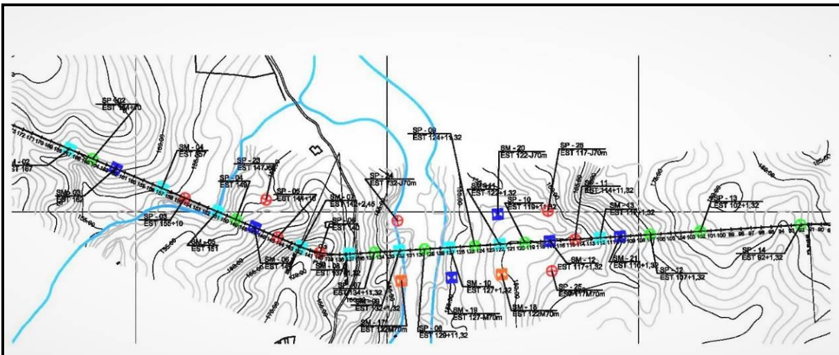
Figura 3.16 - Localização das sondagens no eixo da barragem
