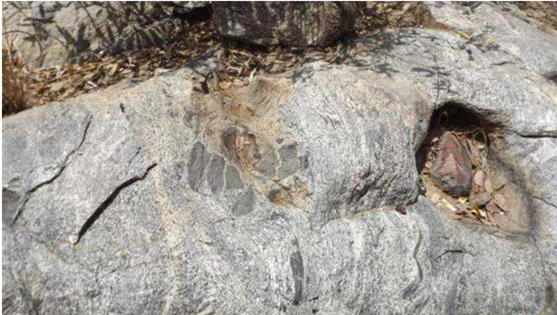
Figura 3.9 - Gnaisses migmatítico exibindo bandamento centimétrico entre melanossomas e leucossomas, injeções quatzo-feldspáticas e restos de anfibolitos fragmentados que por vezes ocorrem em maior quantidade. Leito do Rio dos Macacos com o eixo.
