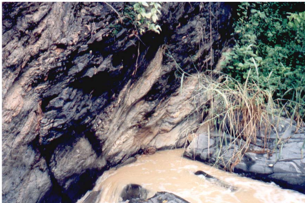
FOTO 06: Jusante do eixo barrável. Acamamento no arenito constituído por lamelas irregulares, selados, mergulhando 60° para jusante (Sul) (12/04/02).
