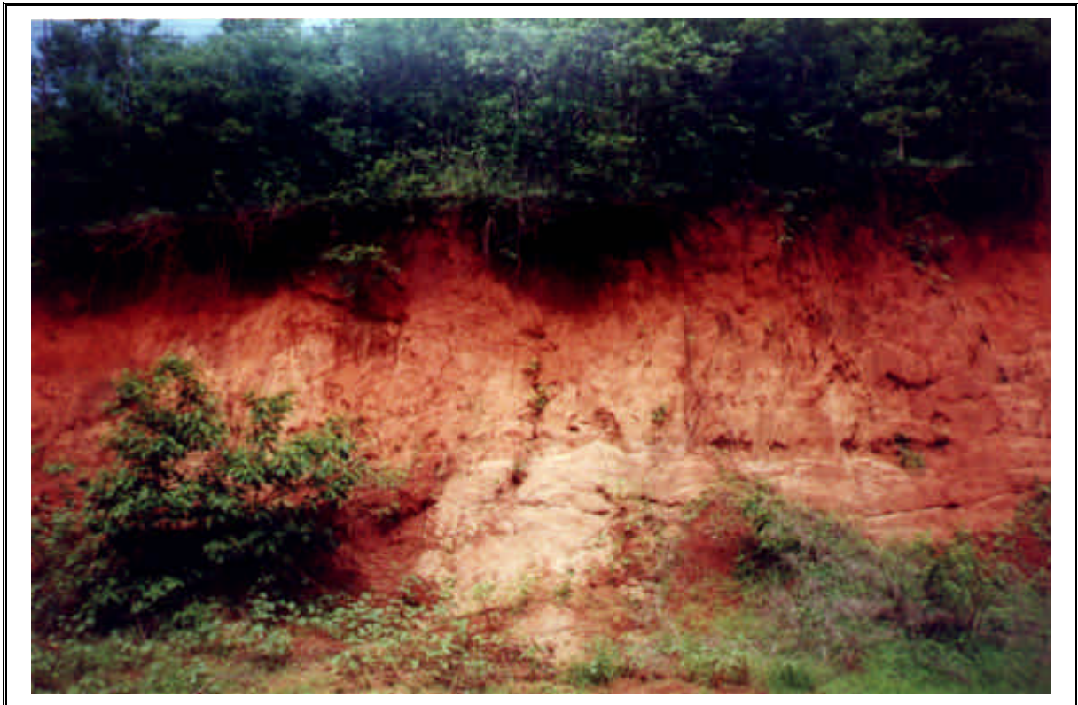
FOTO 03 – DEVIDO AS CARACTERÍSTICAS DA REGIÃO, POUÇOS SÃO OS LOCAIS ONDE SE PODE IDENTIFICAR A GEOLOGIA DA REGIÃO. ESTE CORTE FOTOGRAFADO EXPÕE UM DOS TIPOS LITOLÓGICOS ENCONTRADOS, MATERIAL CLARO NA BASE DA FOTO, E O MANTO DE ALTERAÇÃO E O DESENVOLVIMENTO PEDOGENÉTICO.
