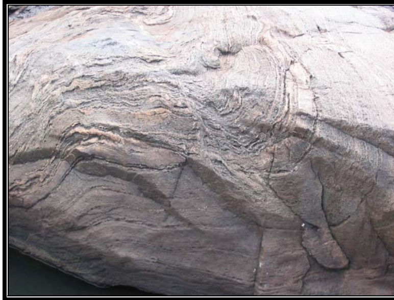
Foto 2 – Gnaisses-Migmatizados apresentando dobramentos e microdobramentos desarmônicos. Ocorrência a jusante do eixo, na variante da estaca 21.
