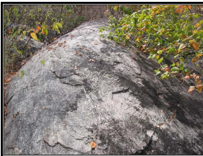
Foto 4 – Migmatitos com concentração de minerais máficos dando a rocha uma coloração cinza escura. Detalhe para a forma de ocorrência do afloramento, esconso ao eixo da barragem, margeando o riacho Conceição. Estaca 14 – eixo.
