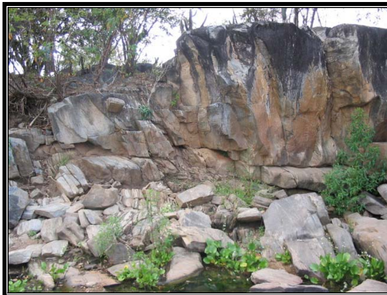
Foto 3 – Migmatitos com concentração de minerais máficos no topo, principalmente a biotita, dando à rocha um aspecto homogêneo de coloração cinza escura. Neste afloramento distinguem-se duas direções de fraturamento, uma sub-horizontal e outra sub-vertical, ocasionando uma compartimentação da rocha em forma de blocos.
