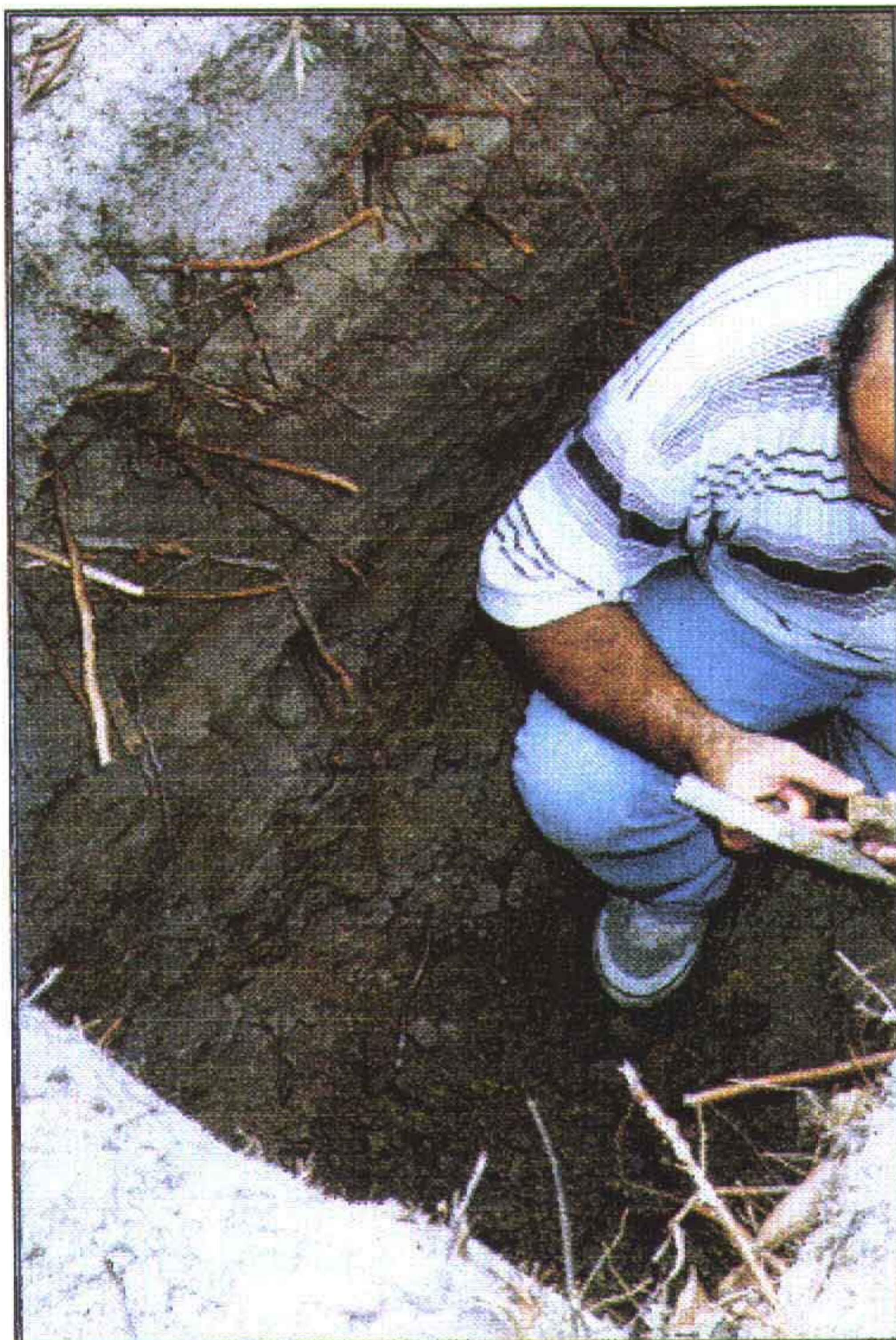
Poço escavado no trecho do eixo da barragem. Observa-se cobertura de solo areno-argiloso com grãos de quartzo, contendo raízes, do Grupo Barreiras, e na base ocorre solo residual de gnaiss/migmatito do Complexo Caicó.
