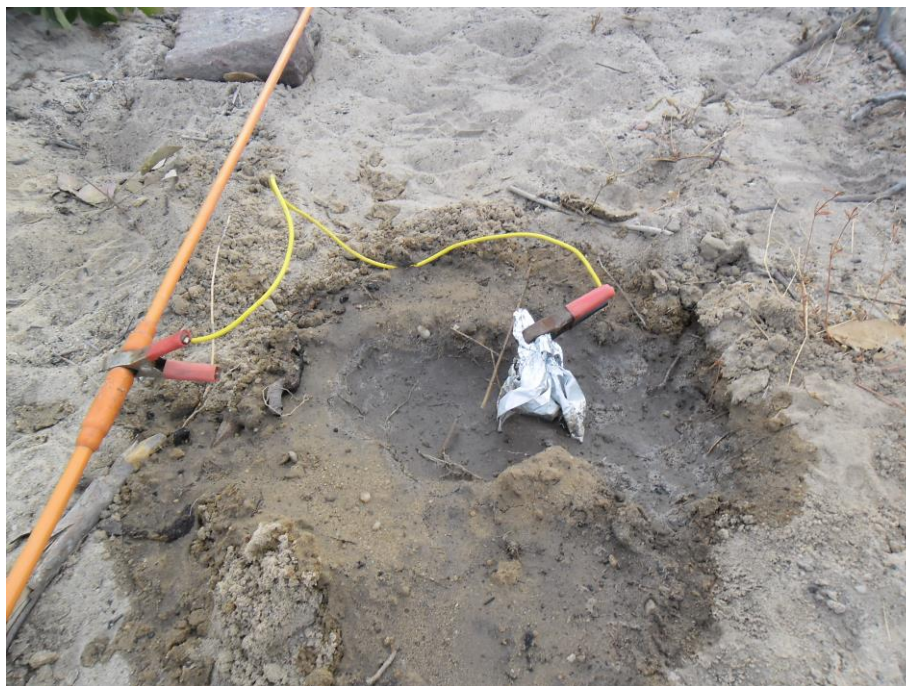
Figura 3.8 - Detalhe do eletrodo de “Papel alumínio” conectado ao cabo multielestrodo.
