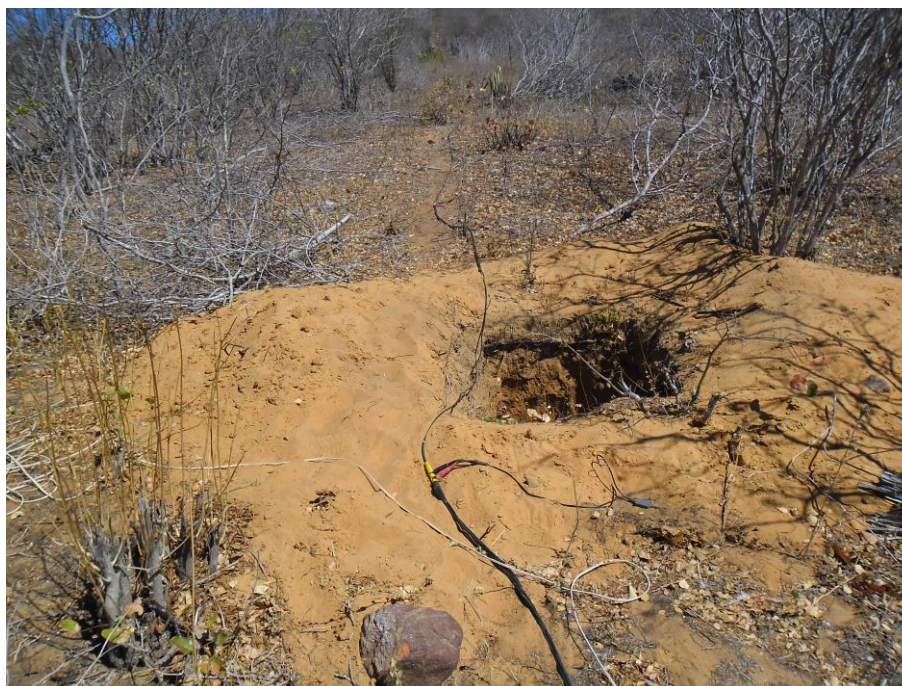
Figura 3.11 - Detalhe do cabo sismográfico e de um dos geofones instalados ao longo do alinhamento.
