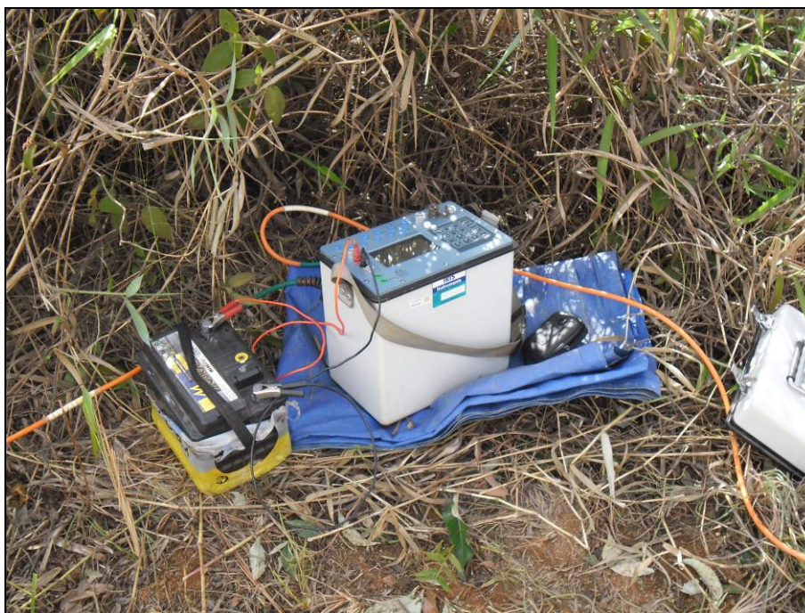
Figura 3.6 - Equipamento de aquisição de dados geoeletricos SYSCAL PRO de 48 canais conectado aos cabos multieletrodos e à bateria.
