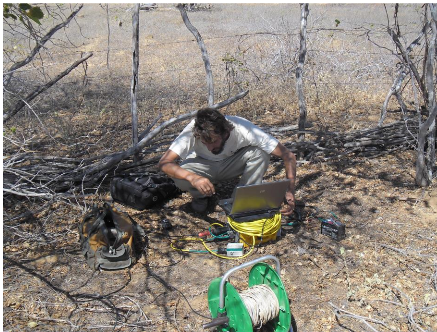
Figura 3.12 - Equipamento sísmico (Geode – Geometrics Inc.) e técnico da Alta Resolução acompanhando a aquisição de dados.
