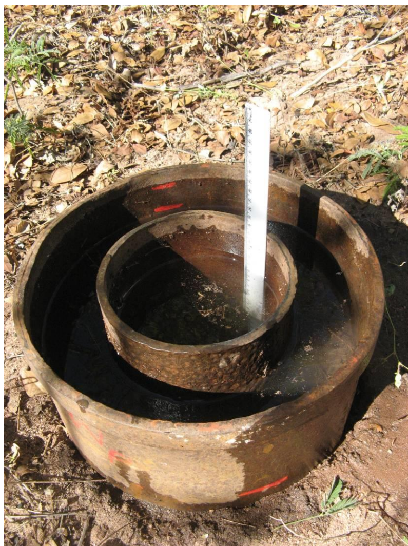
Figura 9.29 - Teste de Infiltração
