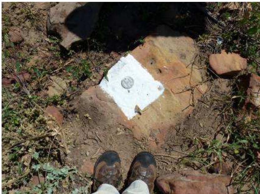
**Foto 3.1: Marco topográfico credenciado n0 006, no alto da ombreira direita da alternativa de eixo Inhuçu 1 (altit. 624 m) (Coord. UTM N 9.512.839 E 285.618).**
