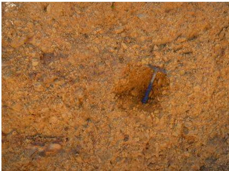
**Foto 3.34: Material granular laterítico em cava em processo de exploração. A ocorrência é de origem coluvionar, tendo sido o material transportado por diversos agentes (Coord. UTM N 9.513.411 E 281.176).**
