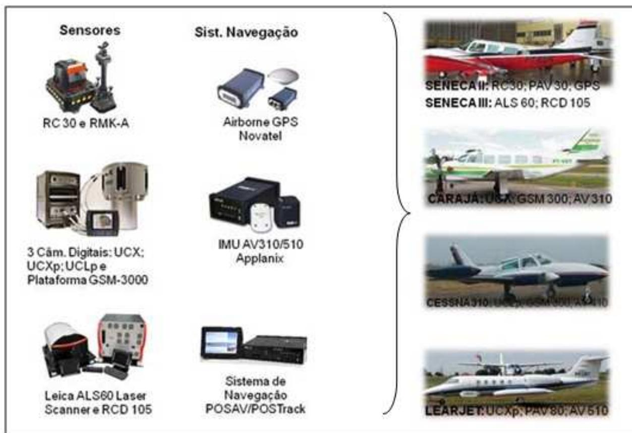
Para a realização das coberturas aéreas, as aeronaves são especialmente adaptadas, equipadas com piloto automático, rastreador de satélites do sistema NAVSTAR - GPS, radar para navegação e com autonomia de 4 horas de vôo.
