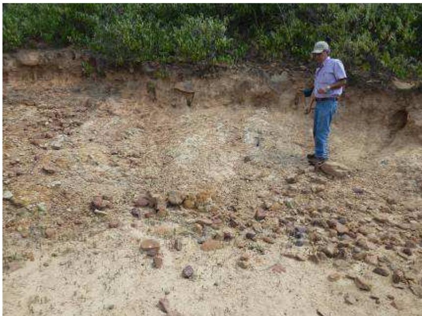
**Foto 3.16: Pequena cava de exploração local, no pé da ombreira direita da alternativa de eixo Inhuçu (do estudo Montgomery Watson/Engesoft) (Coord. UTM N 9.515.231 E 283.916).**
