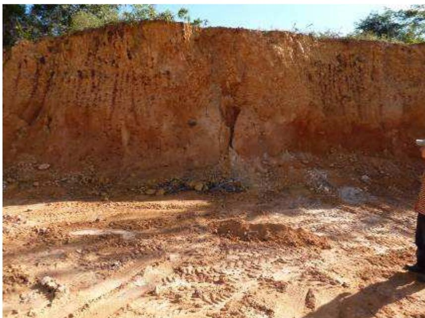
**Foto 3.37: Cava de solo laterítico concrecionado (superficial) seguido, em profundidade, por solo arenoso com características levemente coesivas. A altura máxima do corte é de quatro metros. A cava se situa no distrito de Santa Tereza, afastado da área de interesse aos empreendimentos, mas revela a qualidade dos materiais disponíveis na região (Coord. UTM N 9.536.644 E 296.384).**
