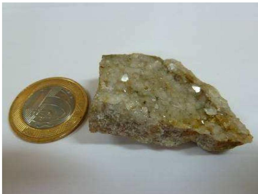
**Foto 3.23: Superfície drusiforme de cristais salientes de quartzo secundário, com faces prismáticas, crescidos em geodo, testemunhando o processo de silicificação do próprio arenito, que adquiriu características de resistência elevada.**
