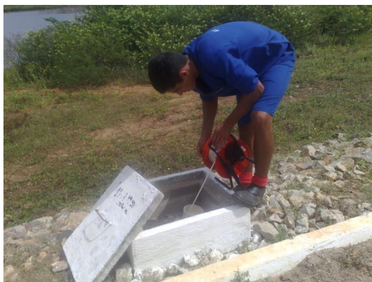
Figura 4.1 – Procedimento de leitura do piezômetro/medidor de nível d'água
