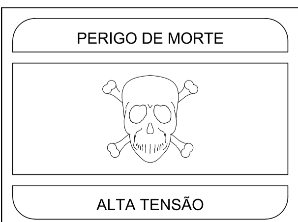
7 DETALHE - PLACA DE ADVERTÊNCIA - PL ESCALA: SEM
