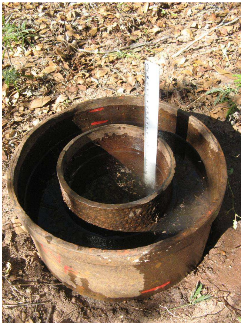
Foto29 - Teste de Infiltração
