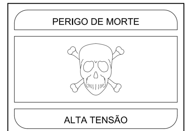
5 DETALHE - PLACA DE ADVERTÊNCIA - PL ESCALA: SEM
