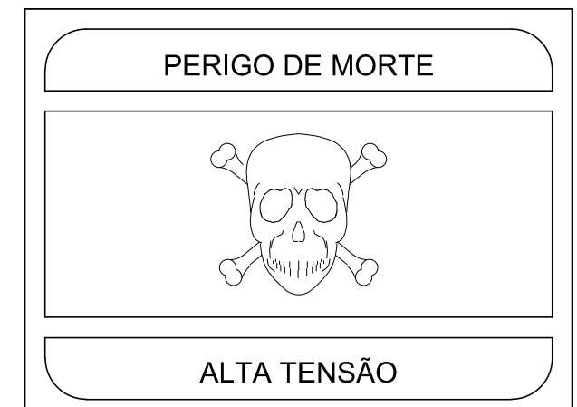
9 DETALHE - PLACA DE ADVERTÊNCIA - PL ESCALA: SEM
