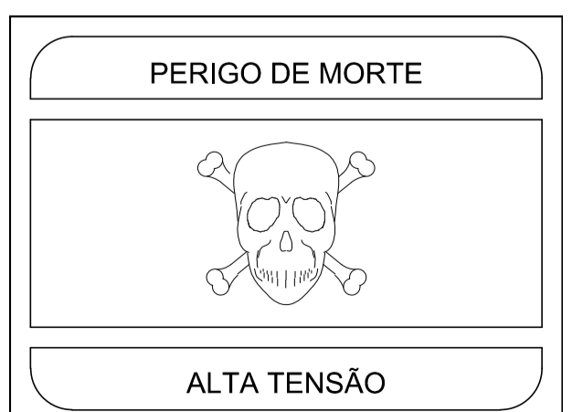
7 DETALHE - PLACA DE ADVERTÊNCIA - PL ESCALA: SEM
