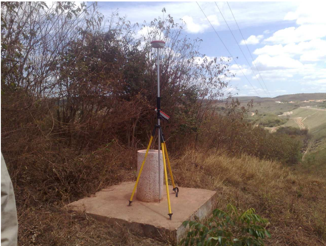
Foto 64 – Levantamento de marco geodésico no coroamento. (17/08/2010)
