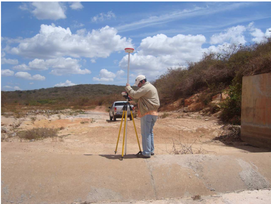
Foto 65 – Levantamento geodésico no Perfil Creager. (17/08/2010)
