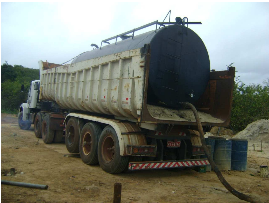
Foto 36 – Caldeira, para injeção de asfalto nos furos de sondagem. (24/06/2010)
