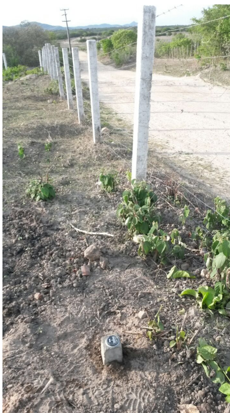
Foto 22 – Aspecto atual da via de acesso não pavimentada. A esq. Presença de marco geodésico.
