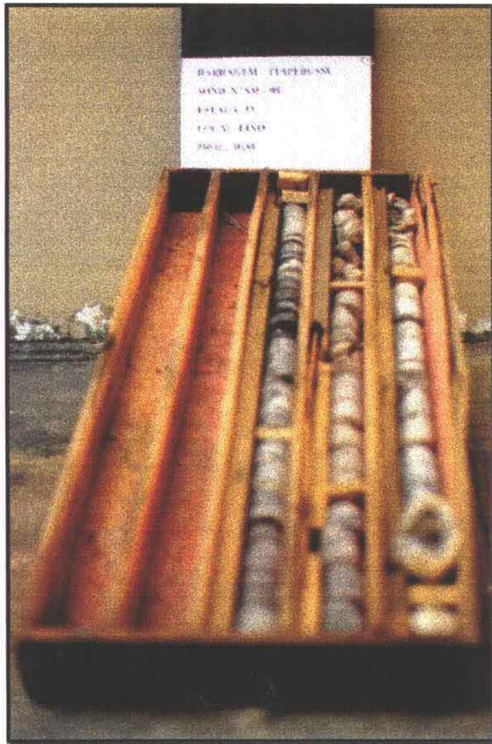
Foto 08 – Testemunho de rocha da sondagem SM – 08. Esta sondagem foi realizada na área do sangradouro
