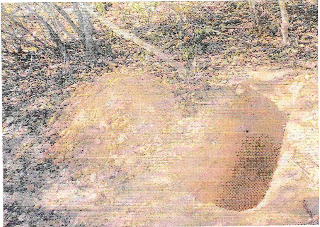
FOTO N° 10 – Furo de sondagem F-19, realizado na área da Jazida J-01, onde observa-se a presença de um silte arenoso argiloso amarelado, sem pedregulho, até 1,10m de profundidade.
