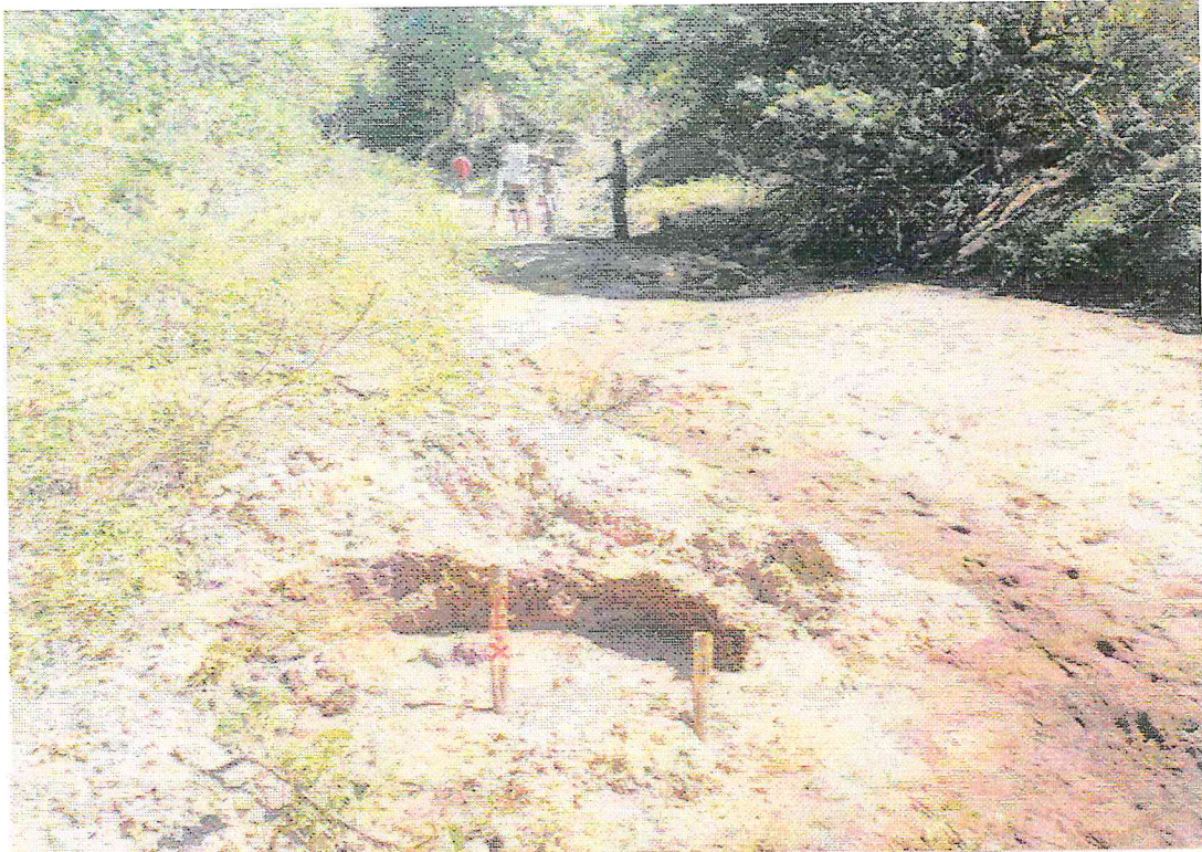
FOTO N° 02 – Foto da região do poço de sondagem SPP-05, realizado no leito do rio, onde não conseguiu-se ir além de 1,50m na areia fina e média pela presença do lençol freático.
