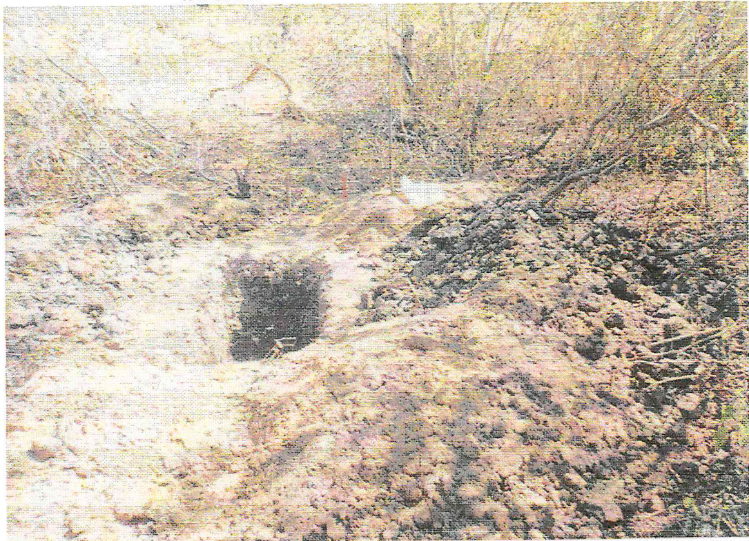
FOTO N° 02 – Foto da região do poço de sondagem SPP-05, realizado no leito do rio, onde não conseguiu-se ir além de 1,50m na areia fina e média pela presença do lençol freático.
