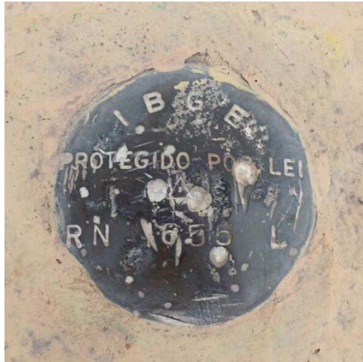
Figura 4.1: Referência de Nível do IBGE, utilizado para transporte e embasamento do nivelamento da Barragem.
