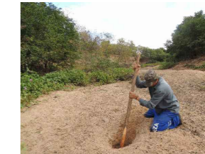
Pt. 05 - Aluvião sem seixos aflorantes areia média e grossa prof. de 1m, N.A. = 60cm.
