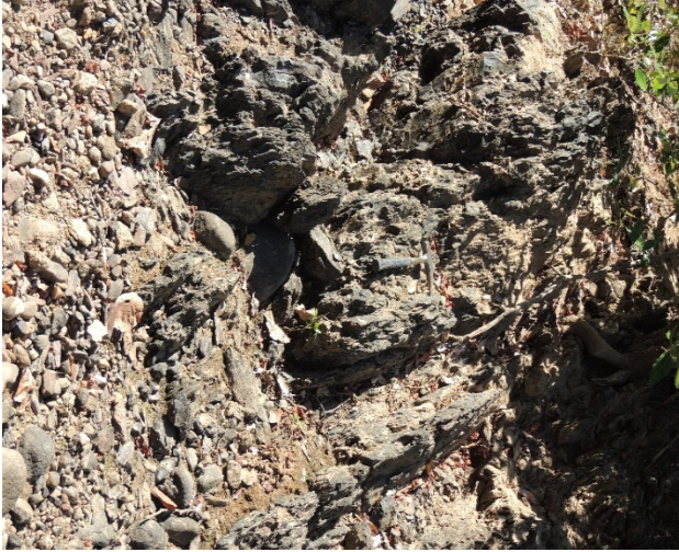
Foto 4.5.24 - Pt. 07- Afloramento de ardósia na margem direita, apresentando laminação bem pronunciada, de direção N58E (E=302.284; N=9.581.842).
