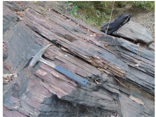
Foto 4.5.39 - Pt. 17- Detalhe da ardósia na margem esquerda, com laminação N05E e plunge 55SE (E=302.213; N=9.581.097).
