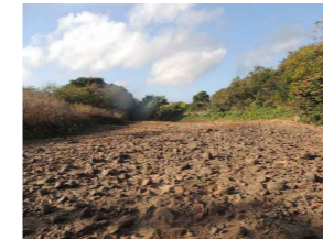
Pt. 01 - Aluvião areia fina e média com seixos de quartzo, calcário e arenito até 30cm.
