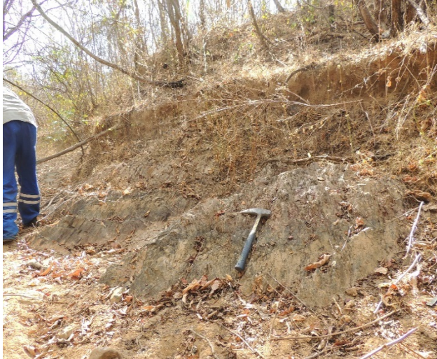
Foto 4.5.7 - Afloramento de ardósia (Est.21+15,00 - 50m p/jusante) abaixo de uma camada de colúvios (silte argiloso com seixos polimíticos de tamanhos variados) (E=302.474; N=9.581.818).
