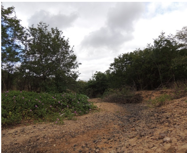
Foto 4.5.22 - Pt .06- Vista para jusante - Aluvião com predominância de seixos pequenos e médios (máximo 30cm) na areia média e grossa (E=302.123; N=9.581.896).
