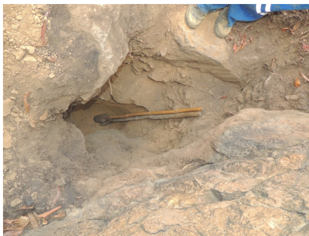
Foto 4.5.43 - Sondagem a pá e picareta com a profundidade de 2,00m (E-302.283; N-9.582.309)
