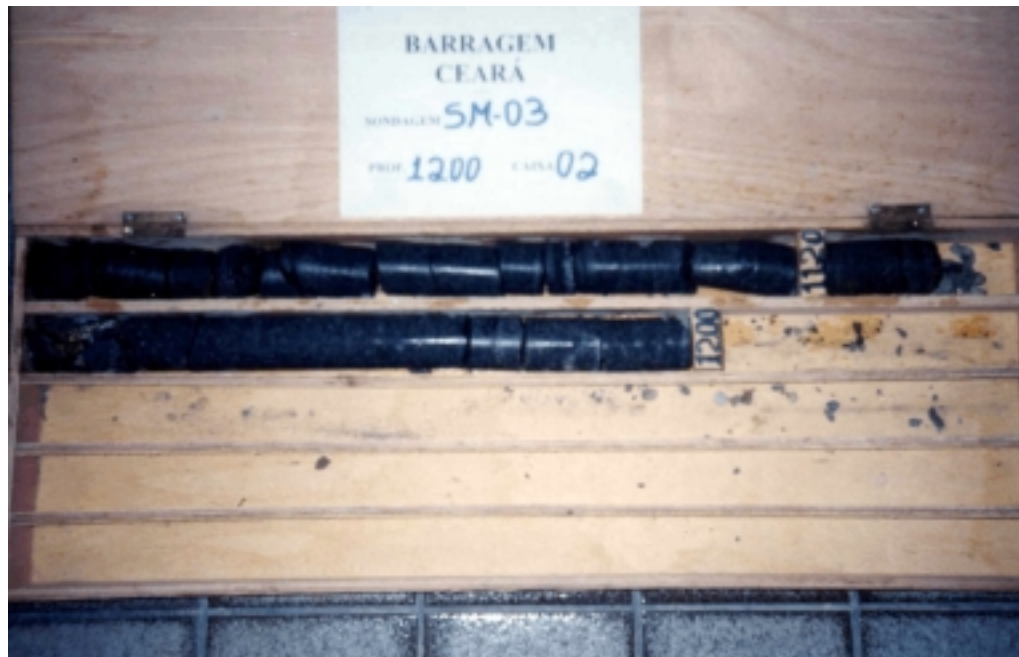
Foto N° 07 – SM-03 Caixa 02 – Trecho 11,20m a 12,00m.
