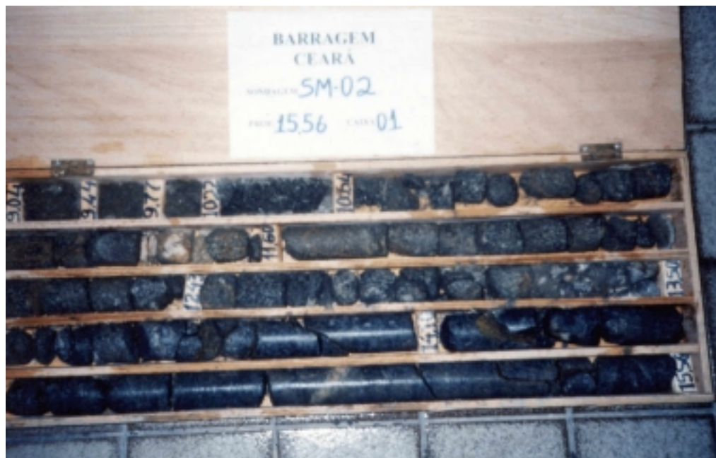
Foto N° 04 – SM-02 Caixa 0 – Trecho 9,04m a 15,56m.
