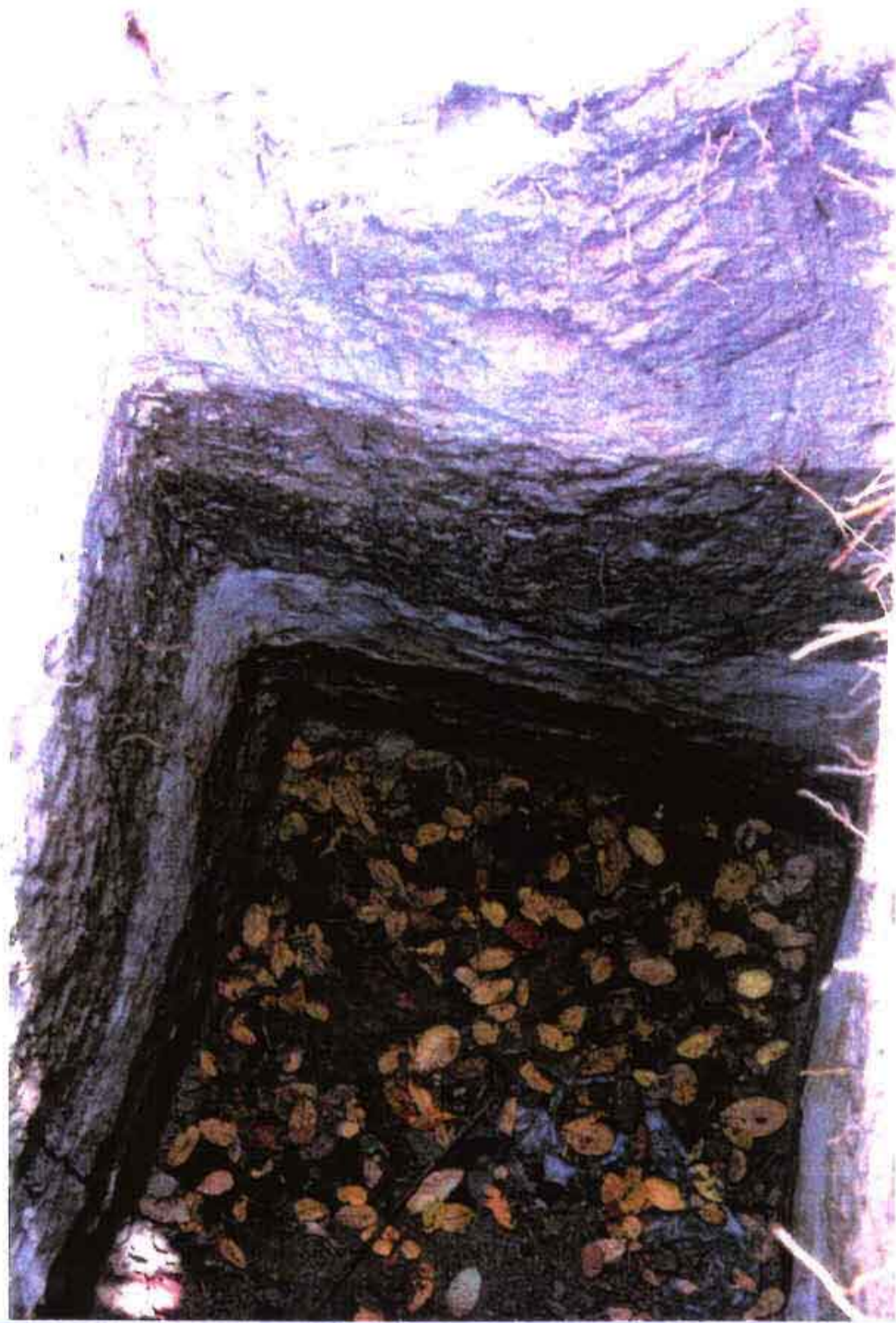
Poço com quase 3 metros de profundidade, piquete 34 (não atingiu a rocha sã)
