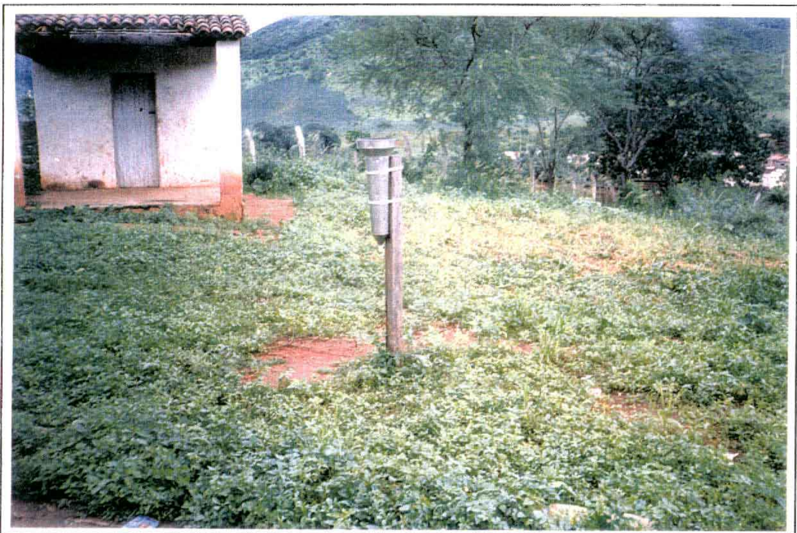
FOTO 36 - ESTAÇÃO PLUVIOMÉTRICA DE ITAPAGÉ II - 2/2
