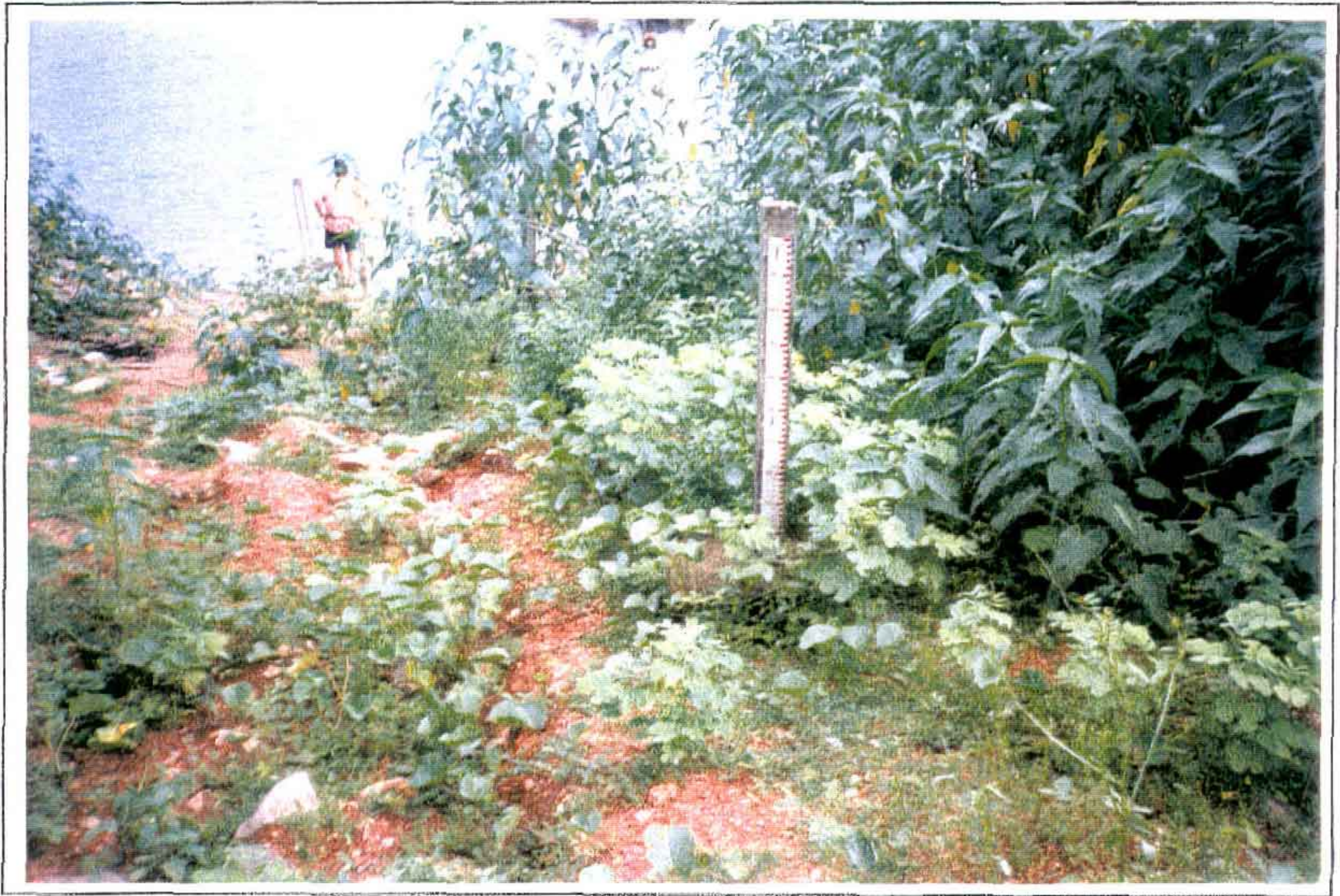
FOTO 72 - ESTAÇÃO LIMNIMÉTRICA DO AÇUDE CAXITORÉ - 3/4
