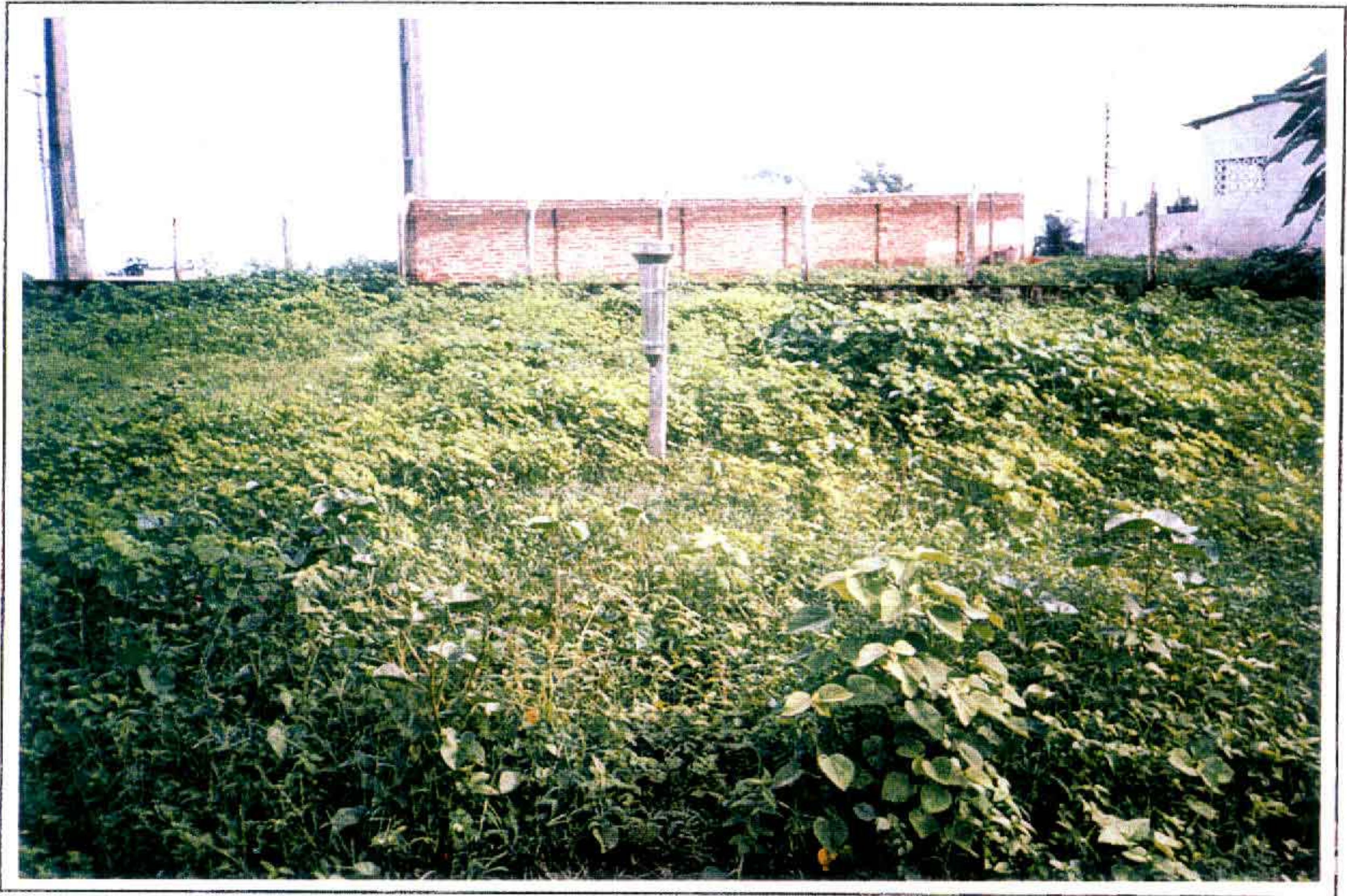
FOTO 03 - ESTAÇÃO PLUVIOMÉTRICA DO AÇUDE PENTECOSTES
