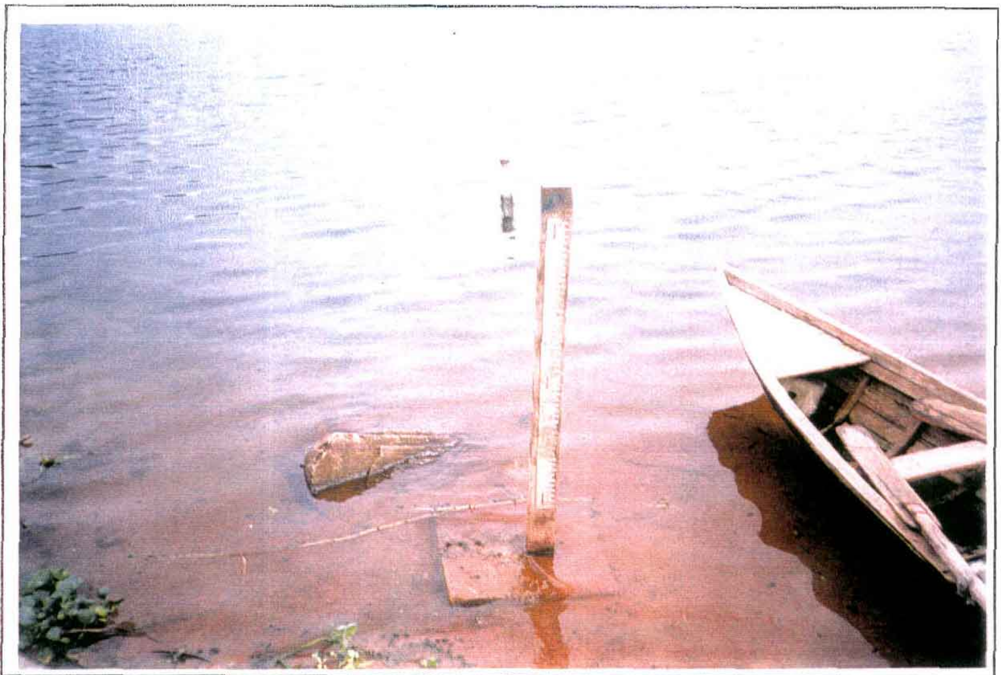
FOTO 73 - ESTAÇÃO LIMNIMÉTRICA DO AÇUDE CAXITORÉ - 4/4
