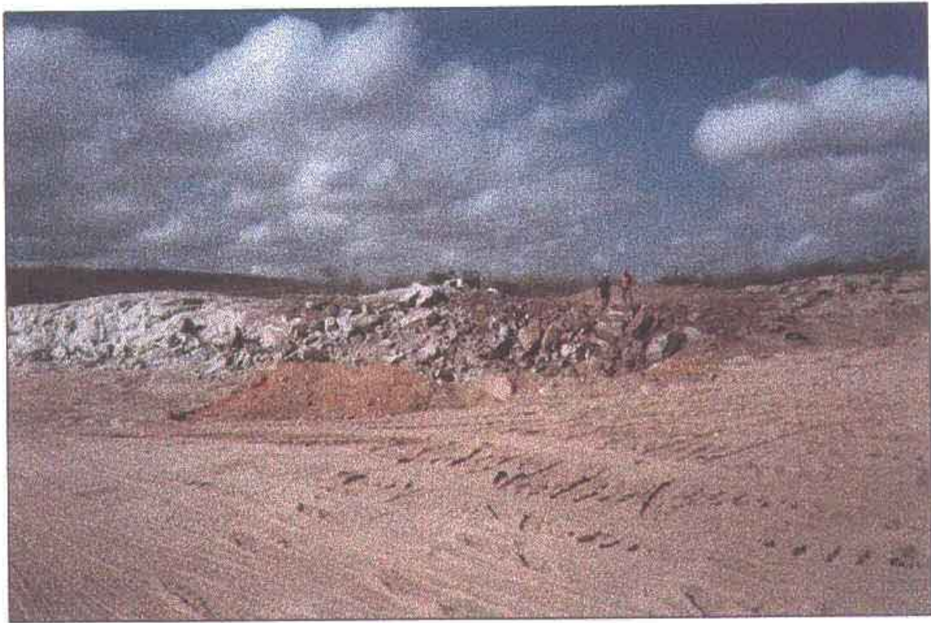
Pedreira em exploração. Observe-se a formação da bancada. No lado direito da foto observe-se o prolongamento da pedreira.
